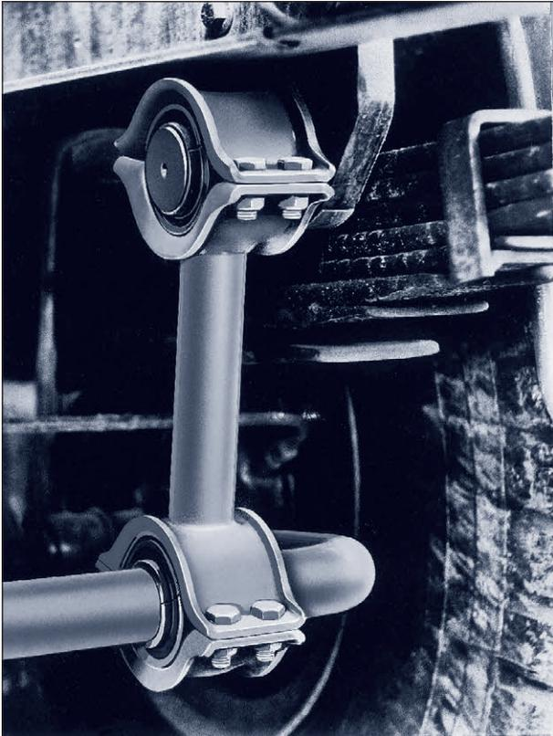
Bei Stabilisator-Systemen werden an jedem Lagerpunkt zwei gegeneinander vorgespannte Gummi-Metall-Buchsenhälften verwendet, die auf dem Stabilisatorstab und dem Außengehäuse nur durch Haftreibung kraftschlüssig gehalten werden. Die Stabilisatorwirkung tritt schon bei kleinsten Ausschlägen ohne Losbrechmoment ein.
