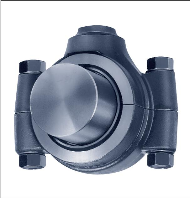
Die Wickelbuchse besteht aus einem gerollten Rohr mit beidseitig aufvulkanisiertem hochelastischen Gummi. Sie ist vorwiegend für Stabilisatorlager bestimmt, kann aber auch als Gelenkbuchse üblicher Art verwendet werden. Die so gewonnene Wickelbuchse umgibt mit der inneren Gummischicht die Innenwelle, z. B. einen Stabilisatorstab und die äußere Gummischicht wird vom Aufnahmeauge unter radialer Vorspannung umschlossen.
